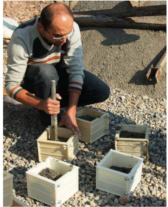
نمونه گیری از بتن در محل کارگاه
